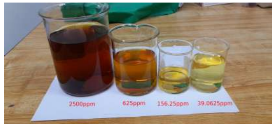
Figura 7: Disolución de nanopartículas de plata 4 veces en agua. Fuente: Elaboración propia
