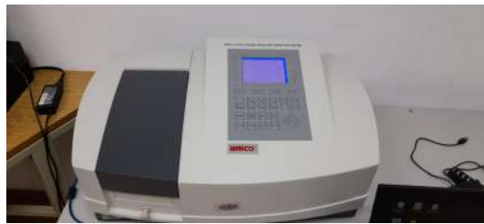
Figura 6: Espectrofotómetro marca UNICO 4802 UV-Vis de doble haz, con un rango 200-900 nm. Fuente: FCFM, UAdeC
